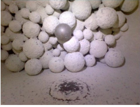
Şekil 3.10 Alçı ile referans koşulunda yapılan test sonrasında Bond değirmenin içinin görünümü
