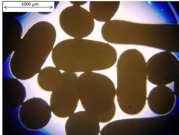
Şekil 3.15. Dibütil Maleat ile kaplanan küresel barutların görünümü
