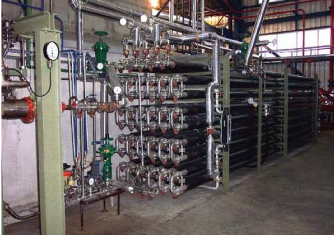
Şekil 2.5.Şekillendirme (boru demeti) ünitesi.
