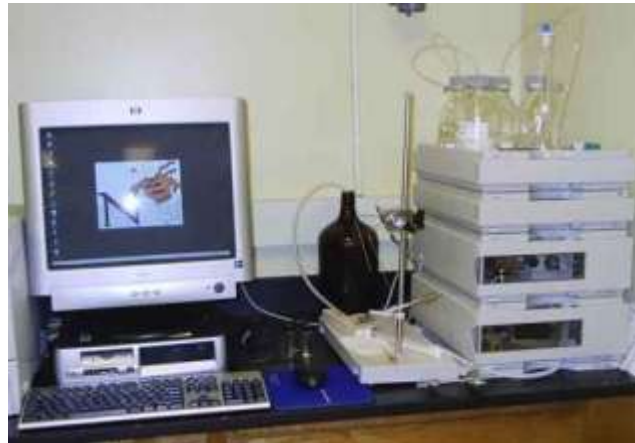
Şekil 3.11. Poli(HPMA-Cl-co-EDMA) partiküllerin ortalama gözenek boyutu, gözenek boy dağılımı ve gözeneklilik oranlarının belirlenmesi amacıyla kullanılan HPLC sistemi [254]
