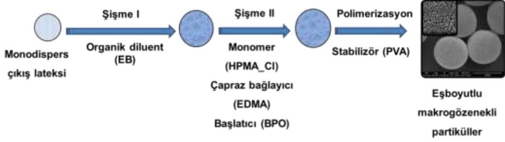
Şekil 3.2. Çok basamaklı mikrosüspanisyon polimerizasyonu yönteminin şematik gösterimi.
