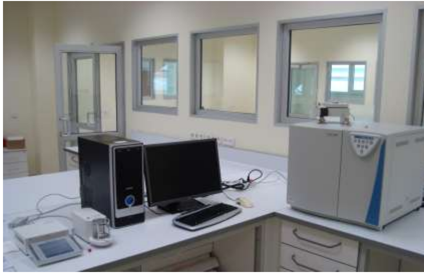
Şekil 3.13. Poli(HPMA-Cl-co-EDMA) partiküllerin ligand içeriklerinin belirlenmesi amacıyla kullanılan CHNS/O Elementel Analiz (Thermo-Scientific, Flash 2000, A.B.D.) cihazı [256]
