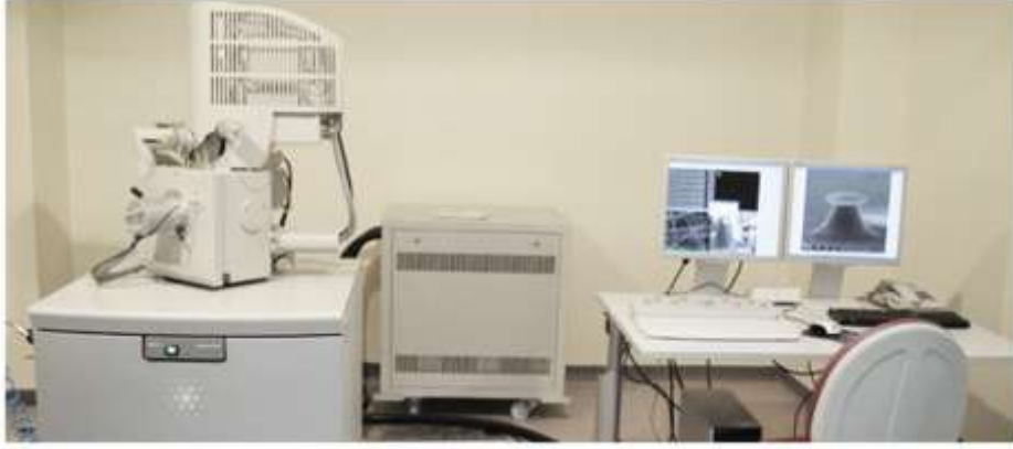
Şekil 3.10. Poli(HPMA-cl-co-EDMA) partiküllerin ortalama boy ve boy dağılım özelliklerinin belirlenmesi amacıyla kullanılan Quanta 200 FEG SEM cihazı [250].
