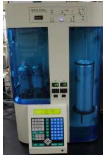
Şekil 3.12. Poli(HPMA-Cl-co-EDMA) partiküllerin yüzey alanlarının belirlenmesi amacıyla kullanılan Quantochrome, Nova 2200e model Yüzey Alanı ve Gözenek Boyutu Ölçüm Cihazı (BET) [255]
