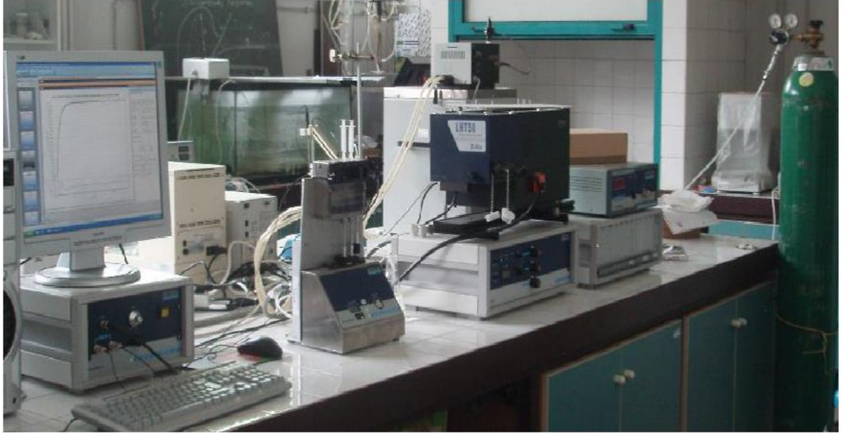
Şekil 3.10 Durdurulmuş akış reaktörü ve ekipmanları
