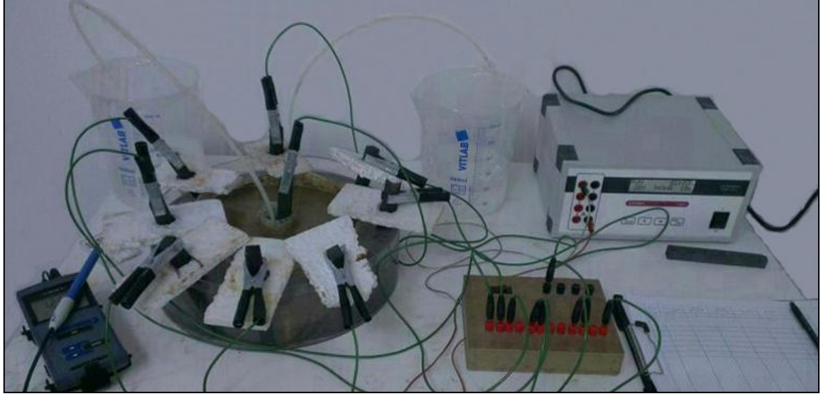
Şekil 3.3. Elektrokinetik düzeneğin kurulu hali.
