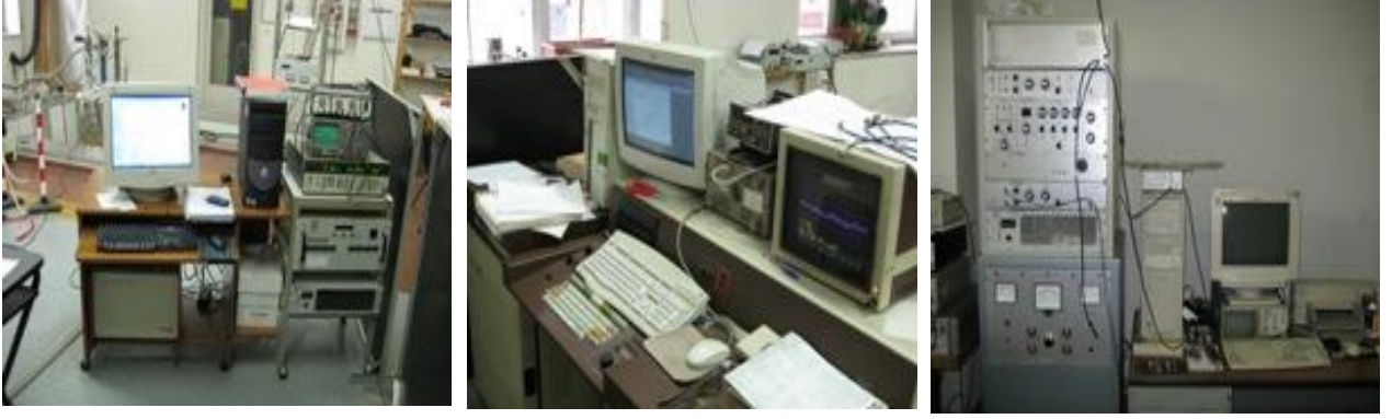
Şekil 3.17 Durulma zamanı ölçümlerinde kullanılan a) Apollo Tecmag 5-450MHz, b) Bruker MSL 200 3-200MHz, c) Mid Continent spektrometreleri.
