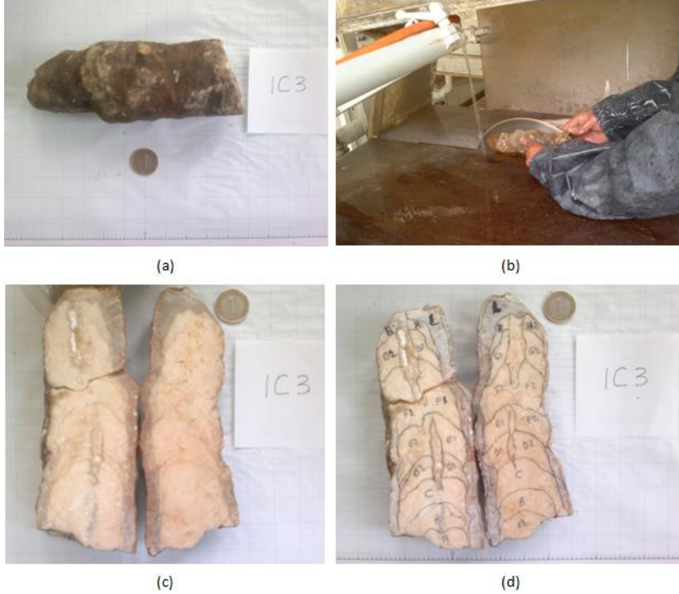
Şekil 3.8. (a) IC3 örneğinin ilk hali, (b) örneğin enine kesilme işlemi, (c) kesildikten sonraki kesit görünümü, (d) katmanların ve örnek bölümlerinin isimlendirilmesi.
