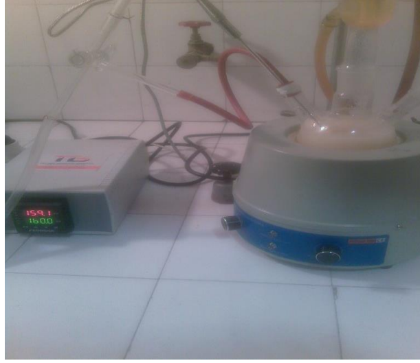
Şekil 3.13. Hidrosis sentez yöntemi
