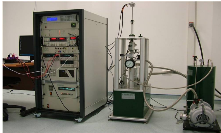
Şekil 3.4. Titreşen örnek magnetometresi (VSM)
