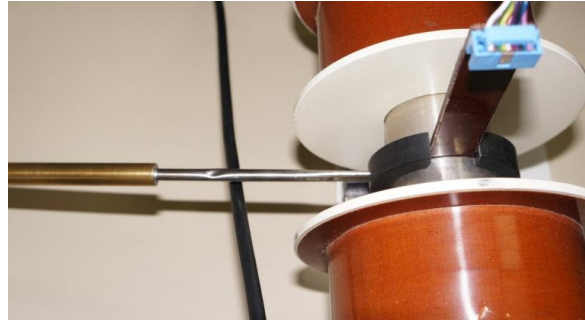
Şekil 3.10. Manyetik alan sensörünün elektromıknatısın kutupları arasındaki örnek tutucuya göre konumu ve siyah delrinden yaptırılan silindirik parça.
