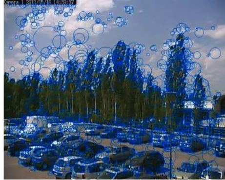
Şekil 5. Görüntülerdeki ilgi noktalarının bulunması [9]
