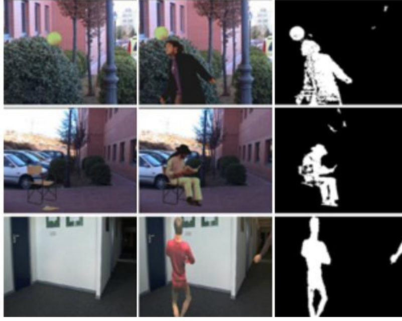
Şekil 9. Arka plan modelleme örneği [14]
