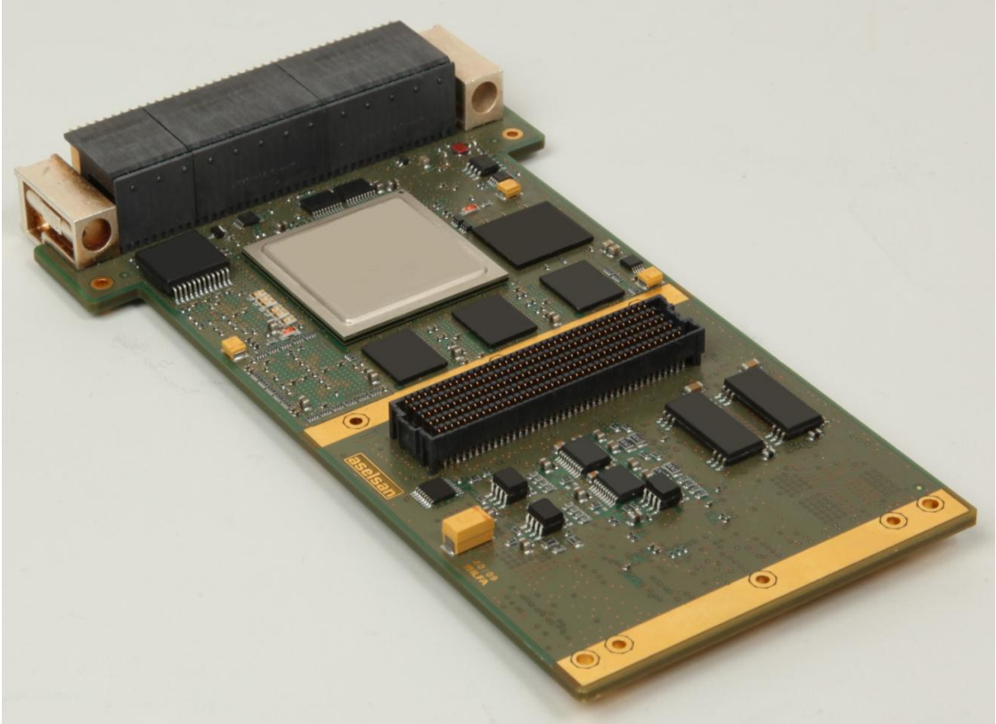
Şekil 13. Virtex5 FPGA'li 3U-VPX sinyal işleme kartı
