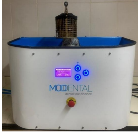
Şekil 3.13 Termal Siklus Cihazı (MOD Dental)
