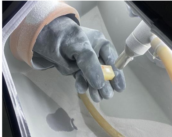
Şekil 3.10 Kontaminasyon sonrası kumlama işleminin yapılması
