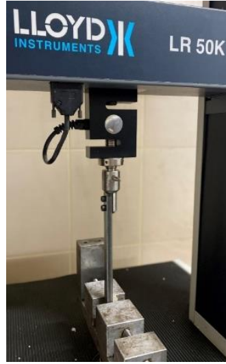
Şekil 3.14 Makaslama testi için kullanılan universal test cihazı
