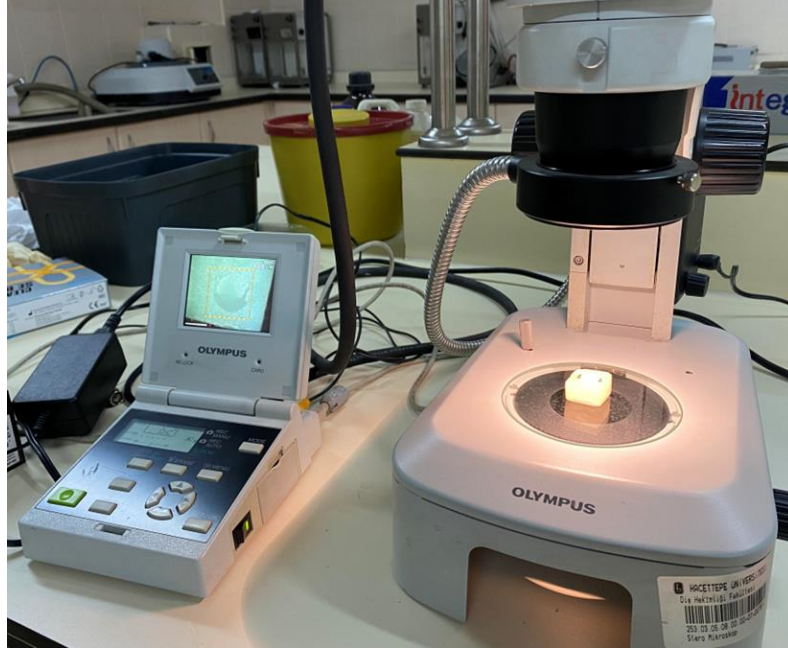
Şekil 3.16 Kullanılan stereomikroskop cihazı
