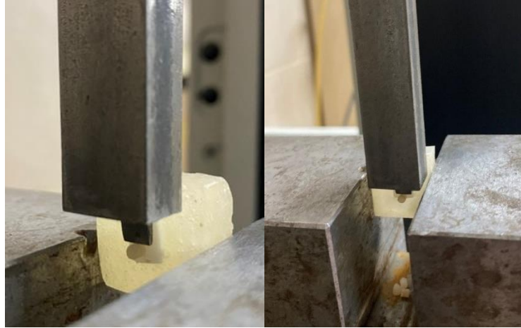
Şekil 3.15 Makaslama testi için cihaza yerleştirilen örnek
