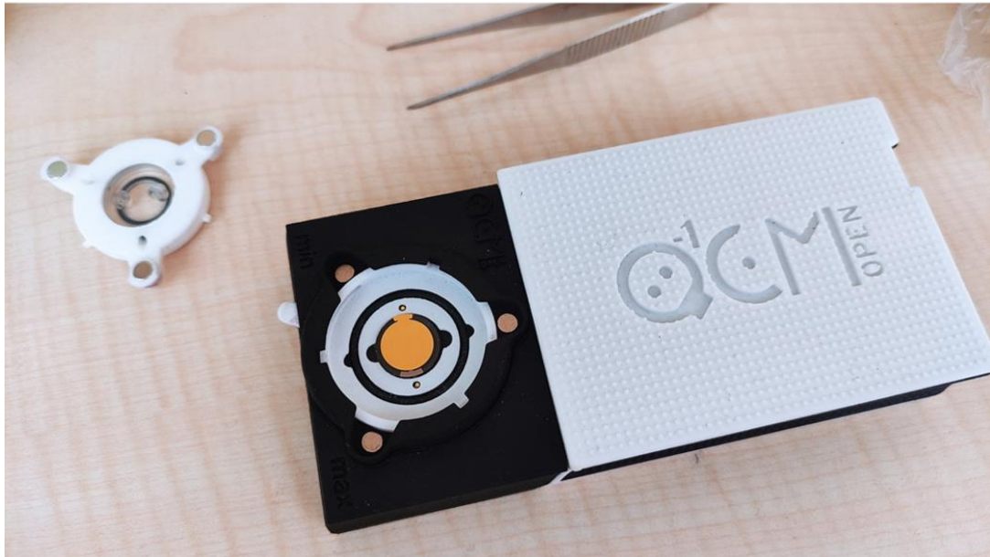
Şekil 3.2. Altın kaplı quartz kristalin görüntüsü ve OpenQCM -1 cihazına yerleştirilmesi.
