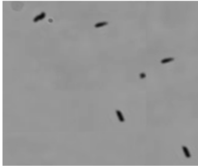
Şekil 4.5. PEDOT/PEDOT-COOH temelli nanomotorlara ait optik mikroskop görüntüsü (3:1 monomer oranı, dopant: LiClO 4 ).
