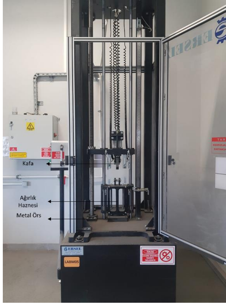
Şekil 3.10 Ağırlık düşürme test cihazı (Ersel Ağır Makina A.Ş.)
