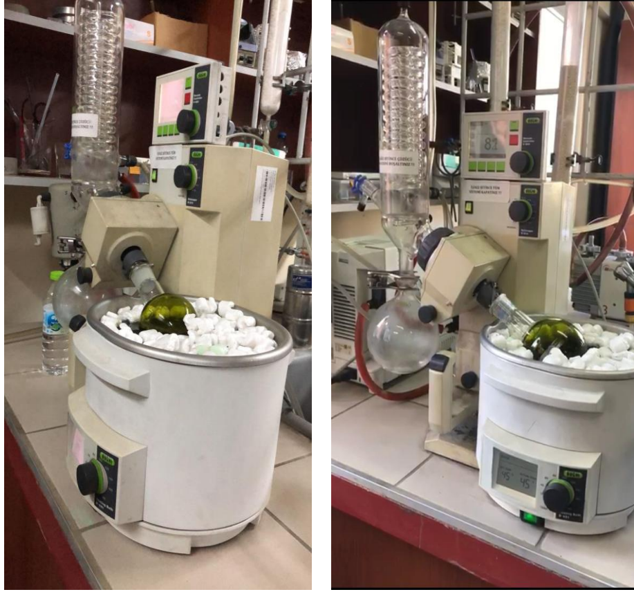
Şekil 3.2. Melocan ekstraktından etanolün uçurulması
