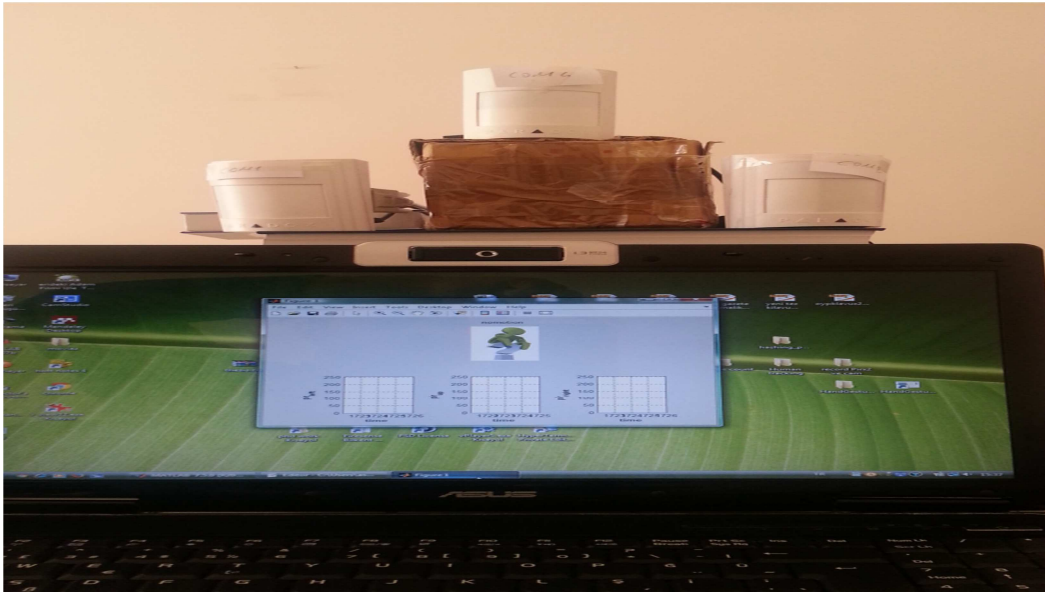
Şekil 2.13. Üç diferansiyel PIR algılayıcı ve bir kameradan oluşan el hareketleri tanıma sistemi
