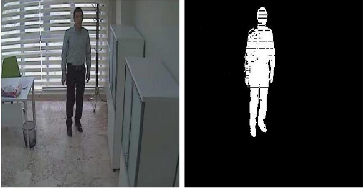
Şekil 5.1. İki aşamalı arkaplan eksiltme metodunun bir kare için uygulaması
