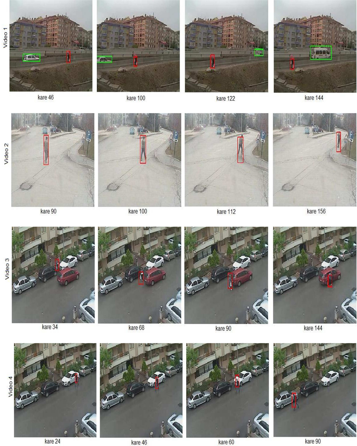
Şekil 5.3. 4 farklı video dizisi için WTA kodları üzerinden tanımlanan mesafe ölçütüne dayalı izleme sonuçları
