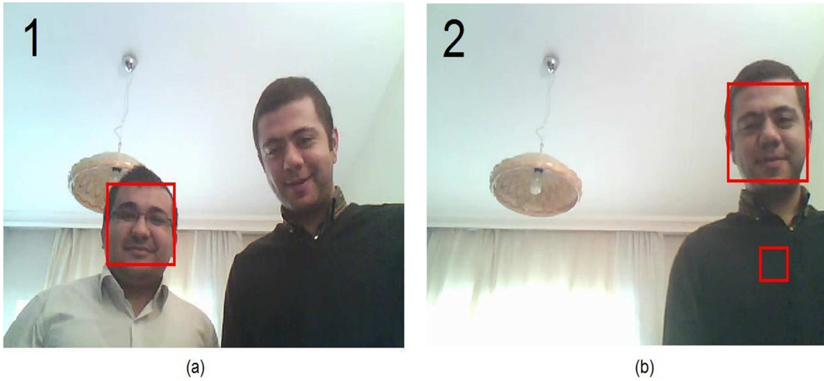
Şekil 3.10. Sadece kamera kullanımı ile yüz saymada karşılaşılan (a) yanlış negatif ve (b) yanlış pozitif örnekleri
