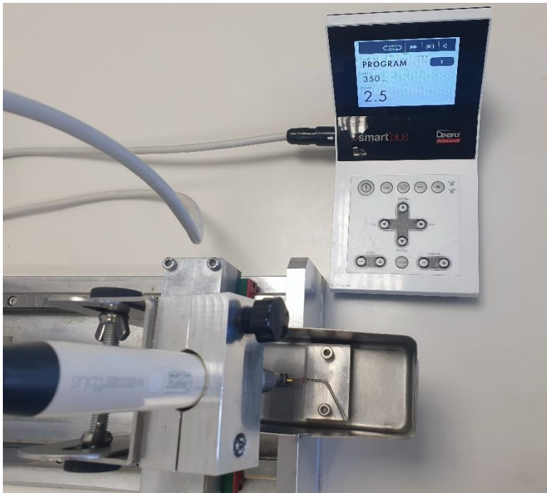
Şekil 3.3. Döngüsel yorgunluk test düzeneği
