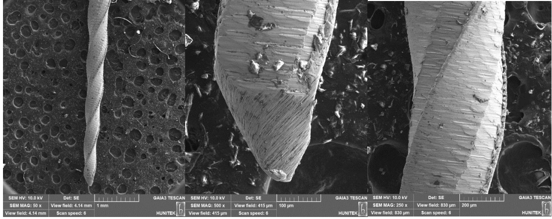
Şekil 4.3. Döngüsel yorgunluk test düzeneğinde kullanılmamış EndoArt Touch Blue eğesinin farklı büyütme altındaki SEM görüntüleri
