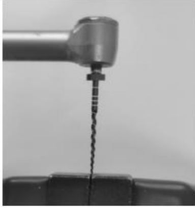
Şekil 2.7. Torsiyonel yorgunluk test düzeneği (150)
