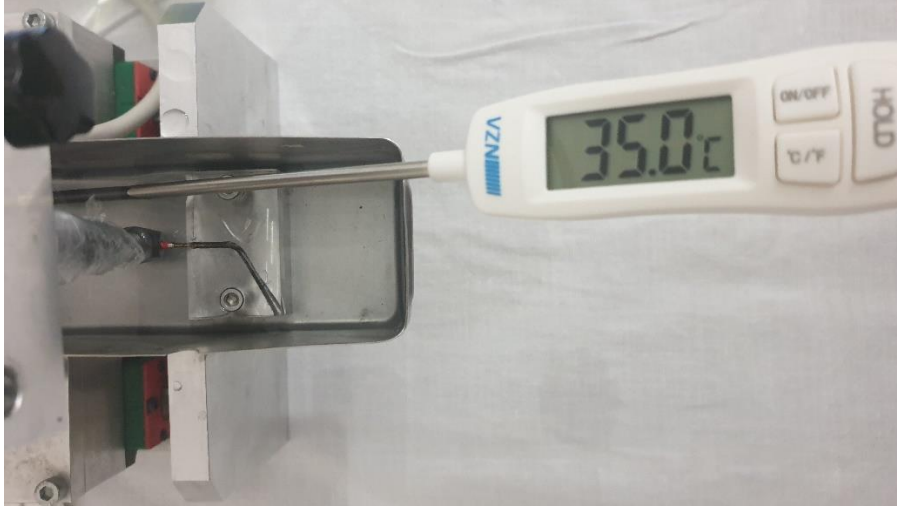
Şekil 3.4. Sıcaklık kontrolü amacıyla kullanılan termometre
