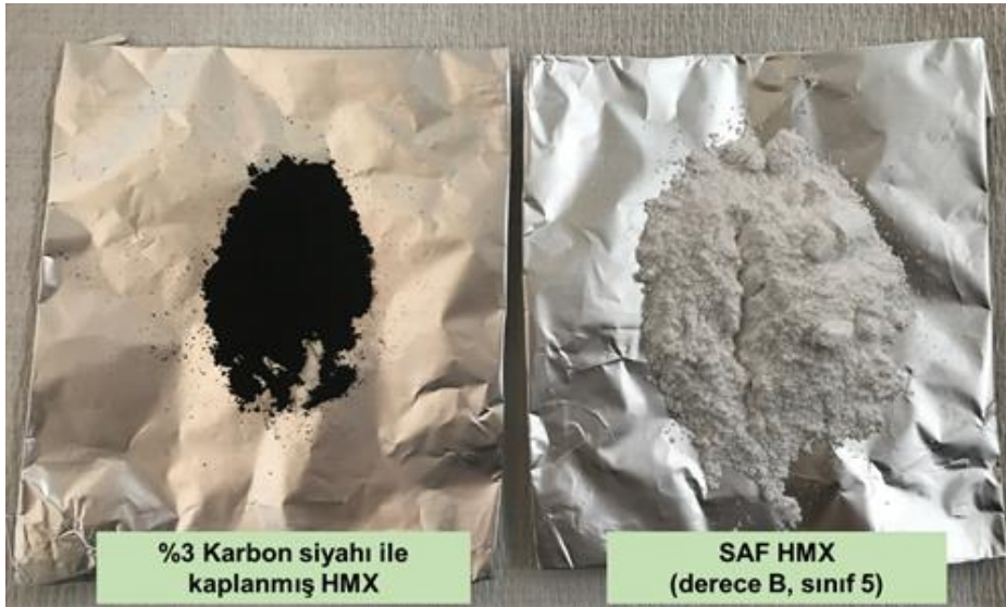
Şekil 5.2. Saf HMX ve ağırlıkça %3 karbon siyahı ile kaplanmış HMX (1. katile)
