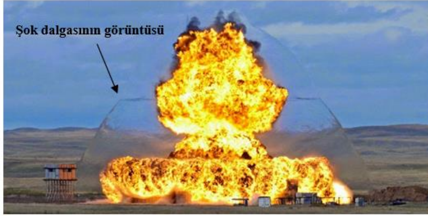
Şekil 2.1. Detonasyon sonucu açığa çıkan şok dalgası görüntüleri, (a) Rusya tarafından geliştirilen termobarik bomba test atışlarından elde edilen fotoğraf (Crimea, Russia September 9, 2016 A thermobaric bomb explosion during the Caucasus 2016 strategic drill), (b) Kanada Savunma Sanayi araştırma geliştirme faaliyetleri sırasında çekilen fotoğraf (DRDC's experimental proving ground supports CAF, allied readiness)
