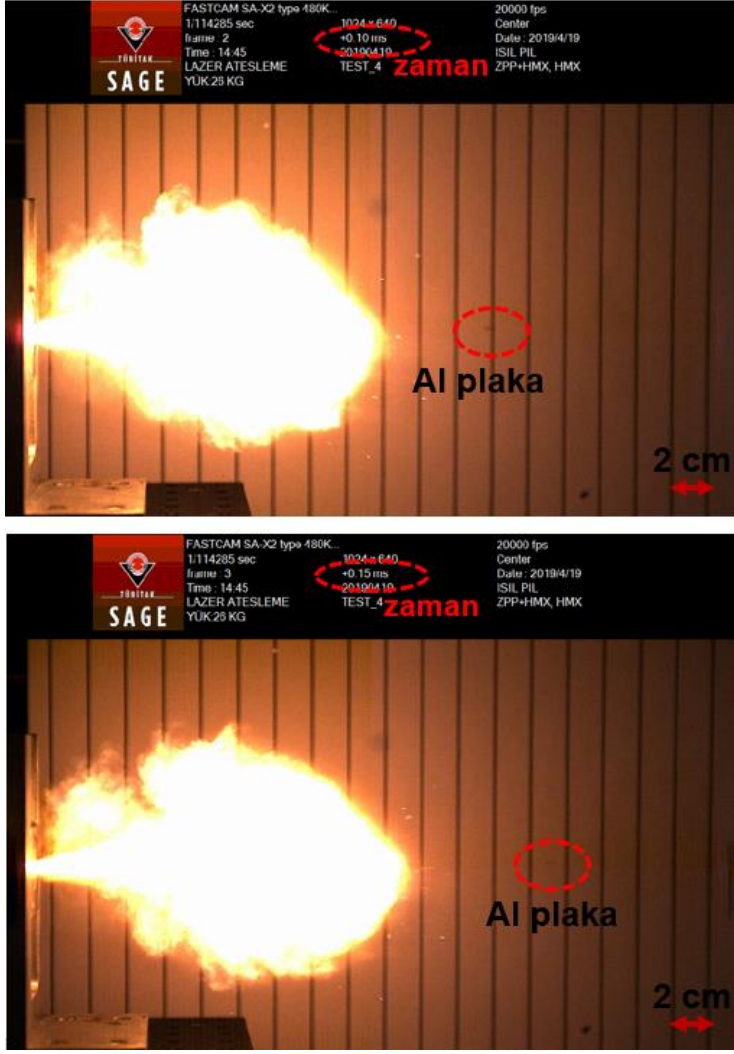
Şekil 7.4. Lazer tetikli uçan plaka hızlı kamera görüntüleri
