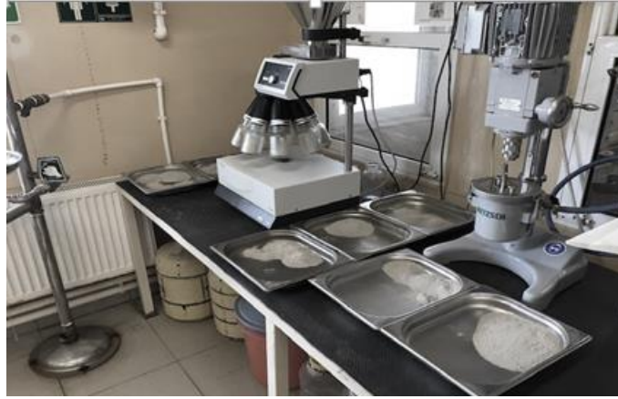
Şekil 3.5. Çalışmada kullanılan Retsch PT100 model döner numune bölücü
