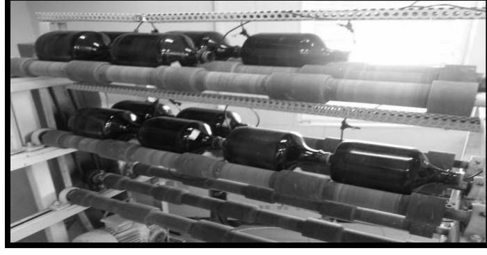
Şekil 3.9. Siyanürleme Testi (Şişe Çevirme) düzeneđi
