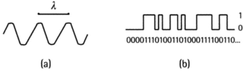
Şekil 2.1.3: (a) Sinusoidal Taşıyıcı Frekans, (b) Dijital Kod [10]
