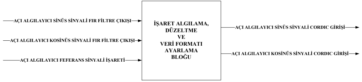
Şekil 3.13 – İşaret algılama, düzeltme ve veri formatı ayarlama bloğu giriş-çıkış sinyalleri
