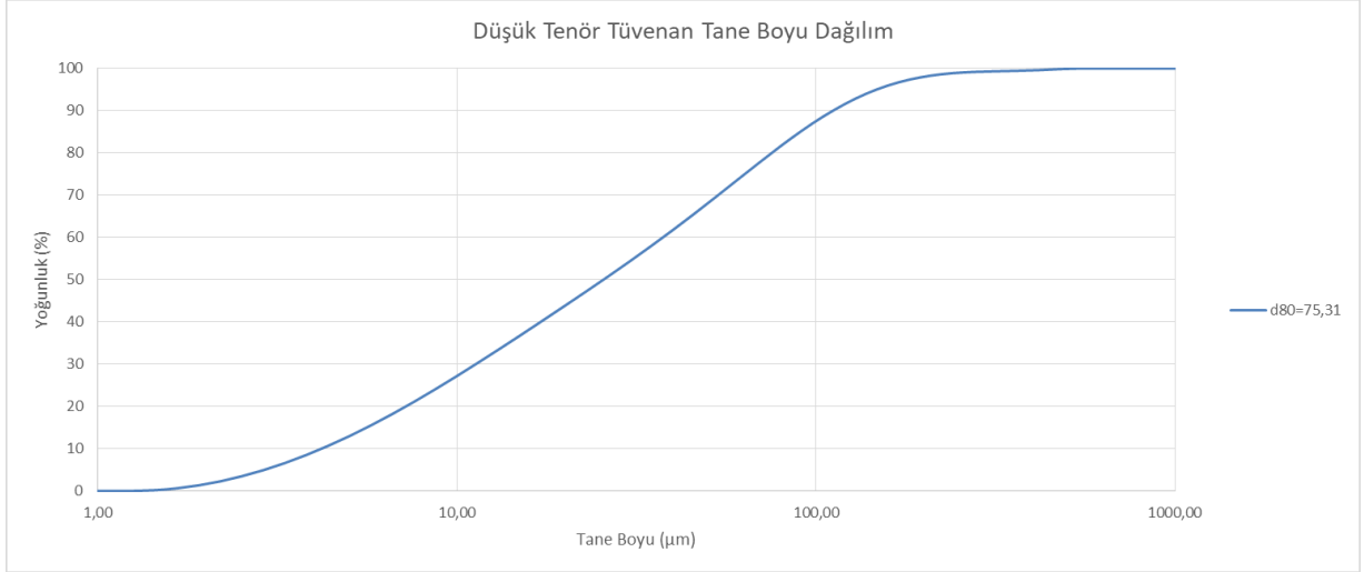
Şekil 3.7. Düşük Tenörlü Cevher Numunesi Tane Boyu Dağılım Grafiği
