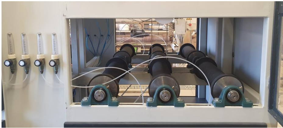
Şekil 3.15. Şişe Çevirme Test Düzeneği
