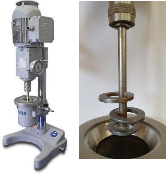
Şekil 3.8. NETZSCH Laboratuvar Tipi Karıştırma Dik Değirmen
