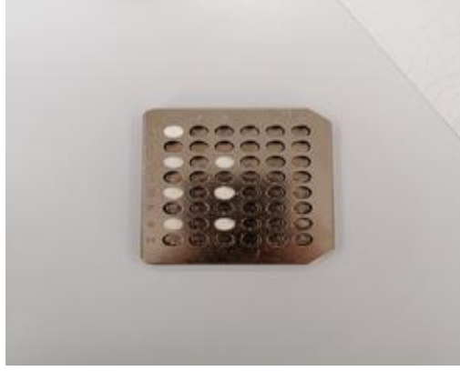
Şekil 3.6. Raman spektroskopisi toz örnekler için uygun olan modül.
