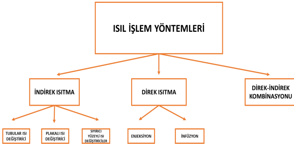
Şekil 2.1. UHT Süt Üretimi için Isıl İşlem Yöntemleri.
