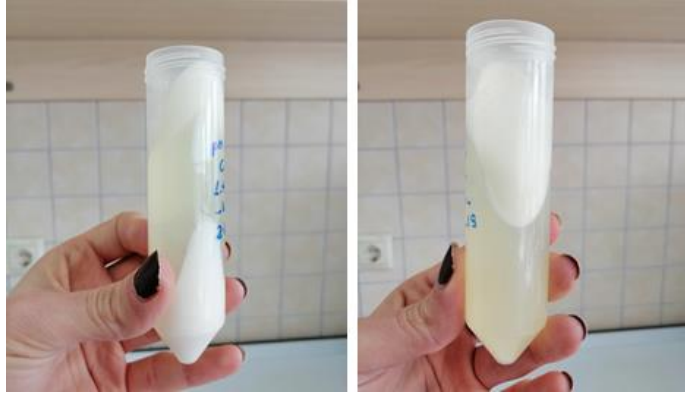
Şekil 3.2. pH4.6'da santrifüj sonrası kazein (presipitat), serum ve yağ fazı (en üst tabaka)
