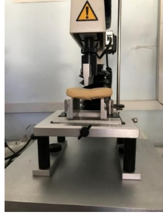
Şekil 4.16. Bisküvi örneklerine ait sertlik (hardness) deęerlerinin ölçümü
