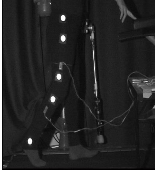
Şekil 2.15 a) Winter'in işaretçi dizilim önerisi b) denek üzerinde işaretçi dizilimi
