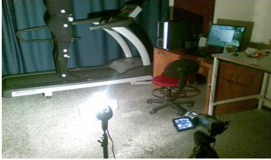
Şekil 2.5 Görüntü tabanlı hareket ölçüm düzeneği [3]
