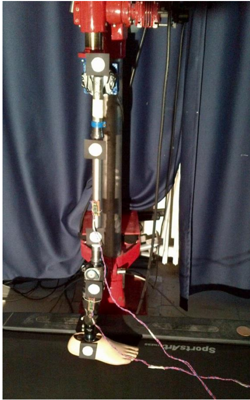
Şekil 3.15 Kalça benzetimleyicisi üzerine hareket ölçüm düzeneklerinin yerleştirimi
