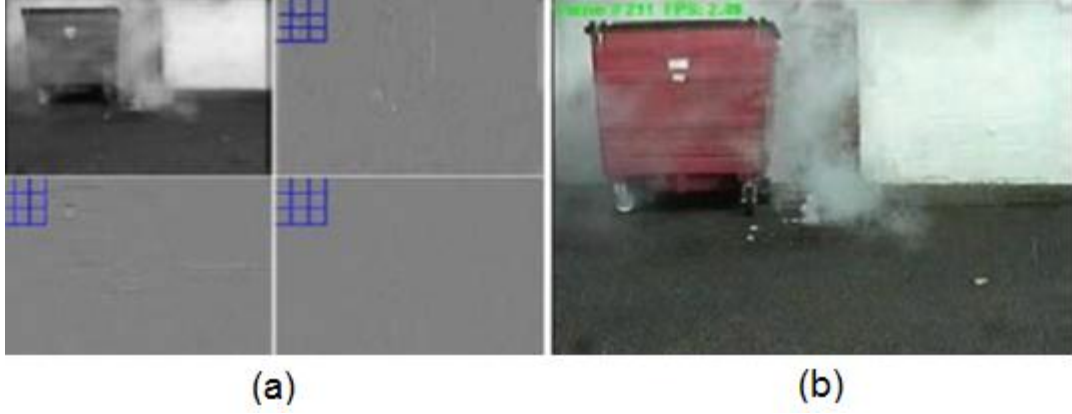
Şekil 3. Dumanlı görüntü karesi (b) ve parlaklık görüntüsünün tek seviye dalgacık alt görüntüleri (a) (a görüntüsünde üst kısım LL-LH, alt kısım HL-HH (L:LPF H:HPF)) [11]
