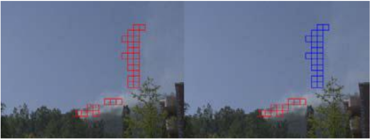
Şekil 6. Anahtar görüntü karesi farkı kullanılarak aday blokların tespit edilmesi ve duman rengi olmayan blokların elenmesi örneği [12]
