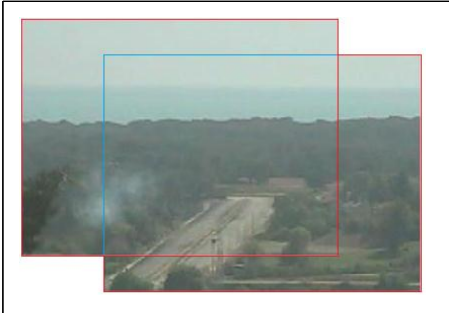
Şekil 20. Arka plan ve anlık görüntü karelerinin hesaplanan tepe noktasına göre kesişiminin gösterimi (Arka plan görüntü karesi önde)
