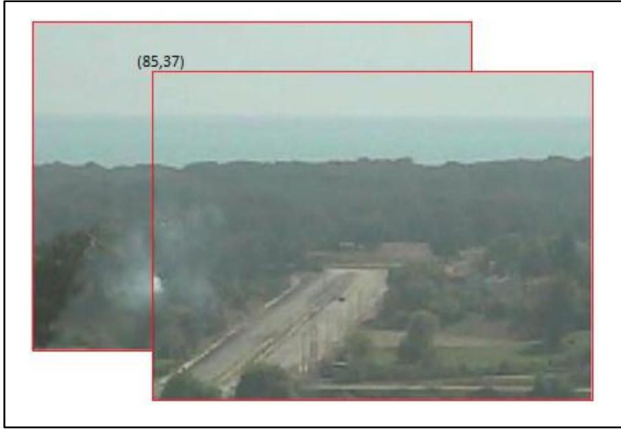
Şekil 19. Arka plan ve anlık görüntü karelerinin hesaplanan tepe noktasına göre kesişiminin gösterimi (Arka plan görüntü karesi arkada)
