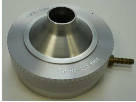
Şekil 3.12. Biyoaerosol örnekleme sistemi- Tek basamaklı impaktör
