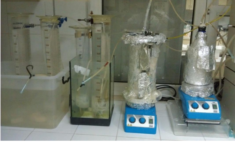
Şekil 5.4. Termofilik RM 1 (2.5 L) ve RM 2 (2 L) metanojen reaktörleri, manyetik ısıtıcı ve gaz toplama sistemi.
