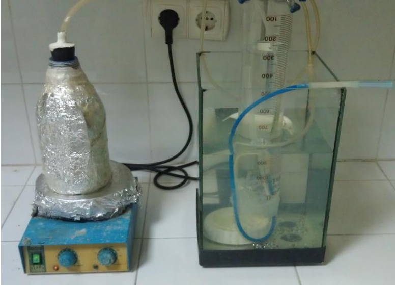
Şekil 5.2. RA (1 L) birinci aşama asitojen reaktörü ve gaz toplama sistemi.
