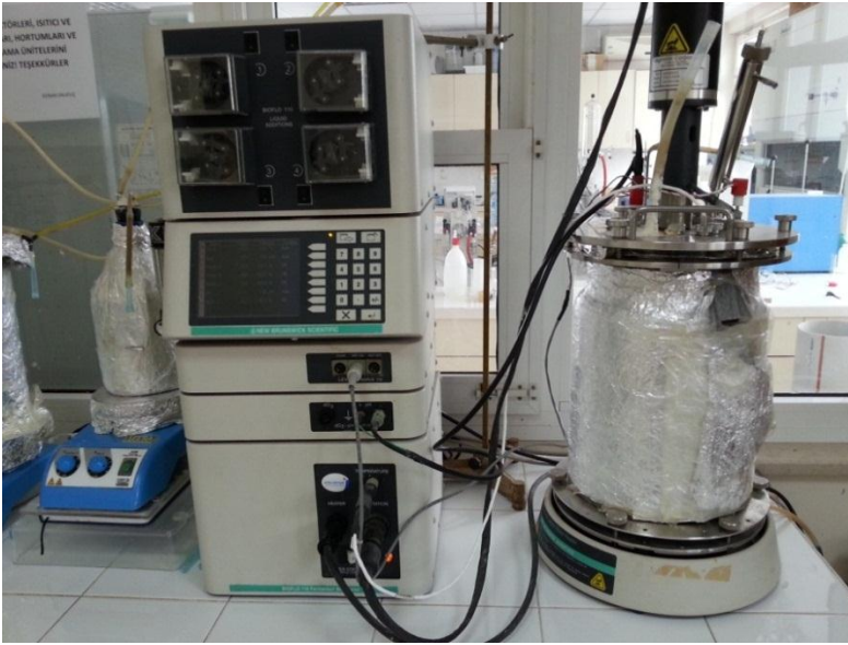
Şekil 5.3. RM (7 L-Biofilo 110) ikinci aşama metanojen reaktörü.
