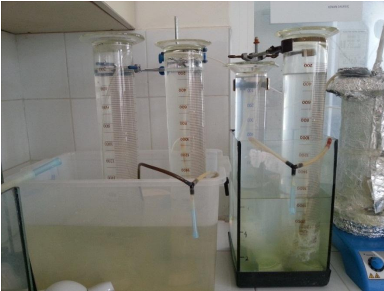
Şekil 5.5. Suyun yer değiştirmesi esasına dayanan biyogaz toplama sistemi.
