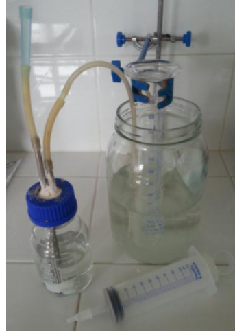
Şekil 5.8. Biyogazın CH 4 oranını belirleme düzeneği.
