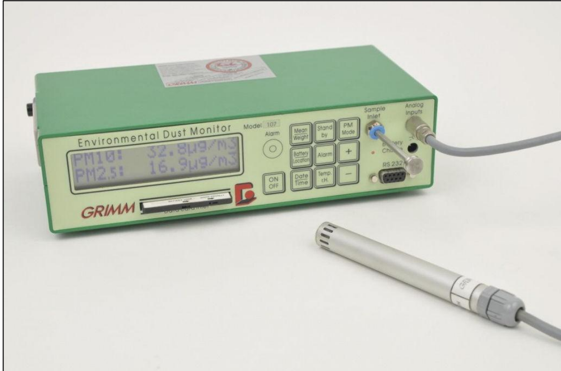
Şekil 3.7 Partikül madde ölçüm cihazı (Grimm EDM 107)
