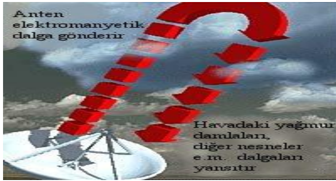
Şekil 2. 3 Radar sisteminin çalışma prensibi (Meteoroloji Genel Müdürlüğü, 2012)
