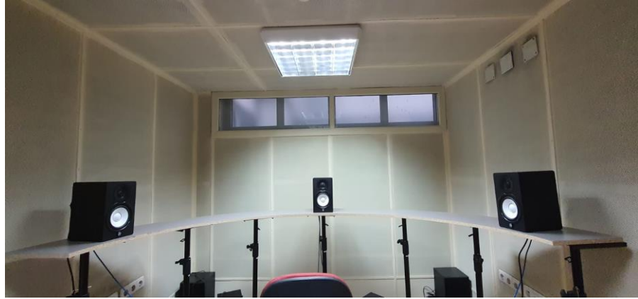
Şekil 3.5. Gürültüde Konuşmayı Anlama Testi için Hoparlör Dizilimi
