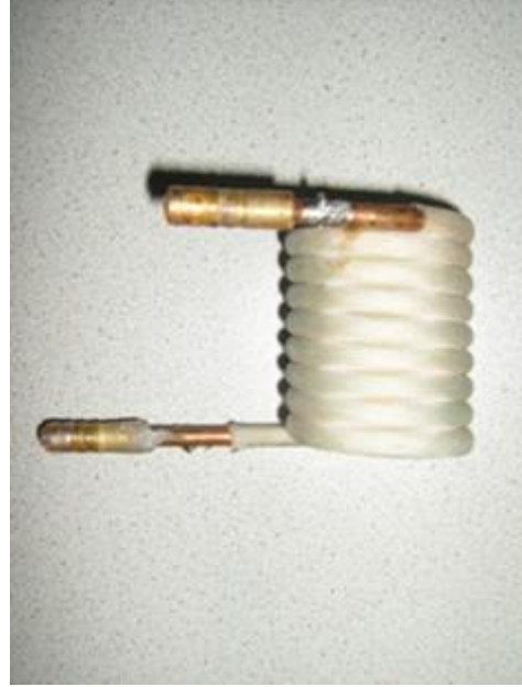
Şekil 13 Endüktif RF jeneratörünün bobin görüntüsü
