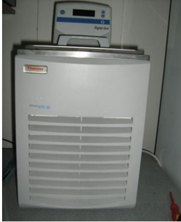
Şekil 12 Endüktif modüllü RF jeneratöründeki kullanılan kriyostat ünitesi
