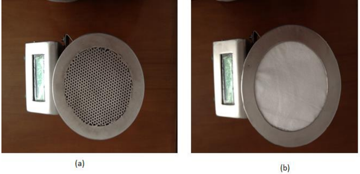
Şekil 4.3. Örneklemeye Başlıkları a) Impaction Yöntemi, b) Filtrasyon Yöntemi
