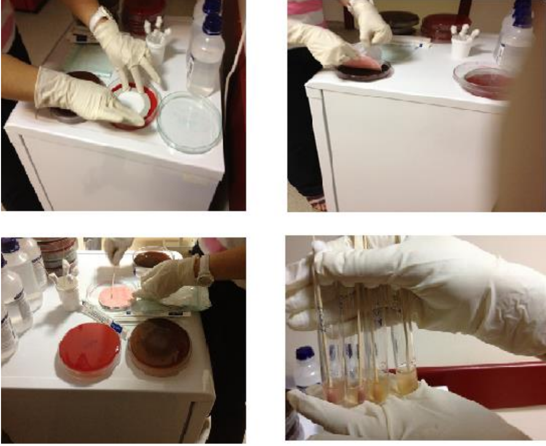
Şekil 4.4. Filtrasyon yöntemi ile yapılan örnekleme sonrası filtrenin besiyerine uygulanması
