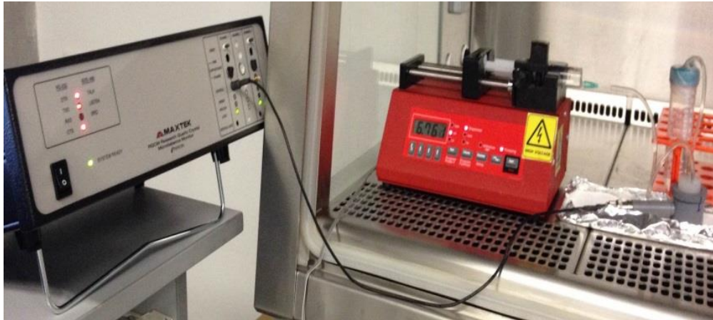
Şekil 3.4 QCM'lerin toksinlerle etkileştirildięi deney düzenneęi
