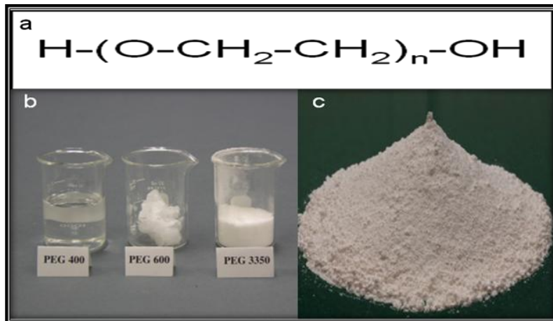
Şekil 2.8. a) PEO'nun kimyasal yapısı, b) (MA:400, 600, 3350 g mol -1 ) ve c) Molekül ağırlıklarına göre değişen PEG/PEO polimerinin fiziksel görünüşleri (MA: 600000 g mol -1 ) [79].
