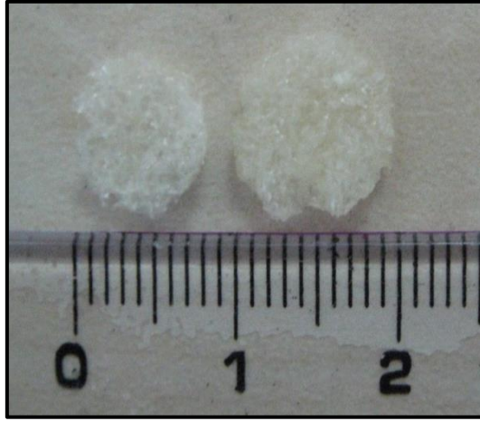
Şekil 4.5.Kitosan-jelatin doku iskelelerinin kuru ve şişmiş haldeki fotoğrafları(sol: kuru hidrojel; sağ: şişmiş hidrojel).
