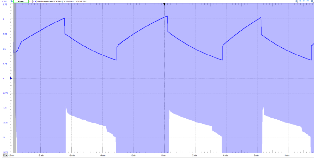
Şekil 4.17. Süperkapasitör ardışık şarj-deşarj döngüsünde gerçek zamanlı ölçüm
