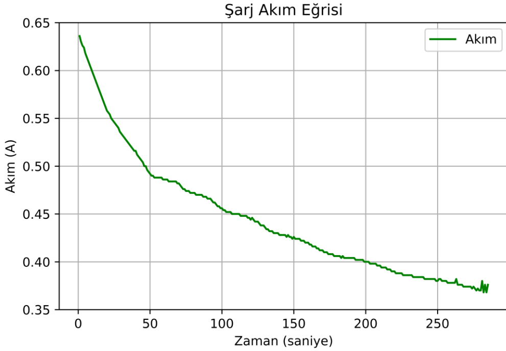
Şekil 4.12. Süperkapasitör şarjı için akım eğrisi
