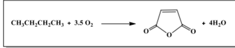
Şekil 18. Maleik anhidritin, bütanın katalitik oksidasyonu ile sentezlenmesi[55].
