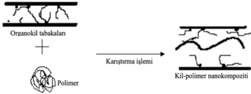
Şekil 8. Polimer-kil nanokompozitlerin eritme yöntemi ile sentezi[23].
