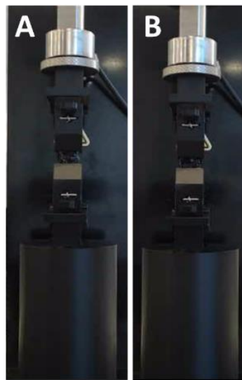
Şekil 4.50. (A) S-Kompozit, (B) SK-Kompozit gruplarının çekme testi esnasında elde edilen temsili görüntüleri.
