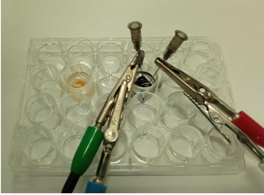
Şekil 3.4. Uygulananan voltaj için prob-malzeme etkileşim sistemi.
