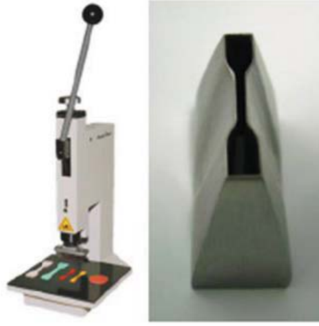
Şekil 3. 9. Zwick ZC020 kesme presini ve ISO 37 Tip 2 numune kesme bıçağı.
