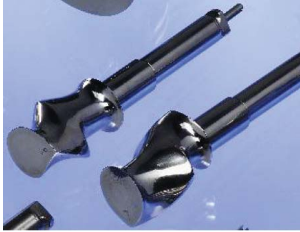
Şekil 3. 2. Karıştırma esnasında kullanılan Banbury tipi rotolar.
