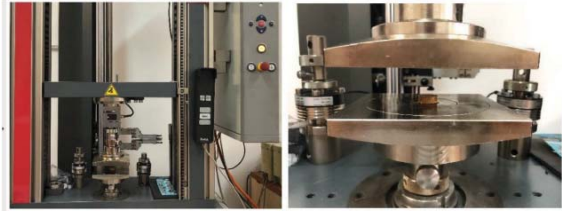
Şekil 3. 12. Zwick Z010 Evrensel Test Cihazı ve basma test aparatı.
