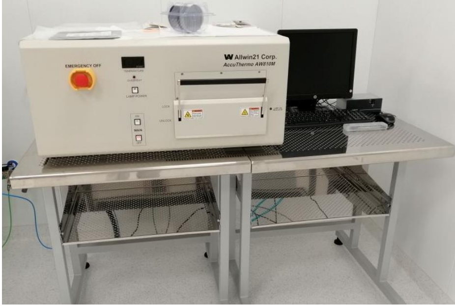
Şekil 6-6 Hızlı ısıtma işlemlerinin gerçekleştirildiği Allwin AW-810 sistemi.
