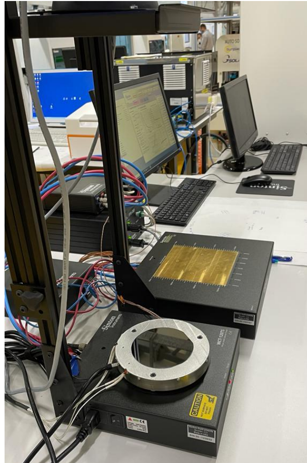
Şekil 7-1 Sinton WCT-120 sisteminin ölçüm tablasına alttaş yerleştirilmiş durumdaki görünümü.
