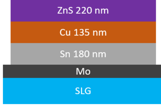
Şekil- 35: SLG/Mo/Sn/Cu/ZnS öncül filmin katman kalınlıkları ve sırasını veren şematik gösterimi.
