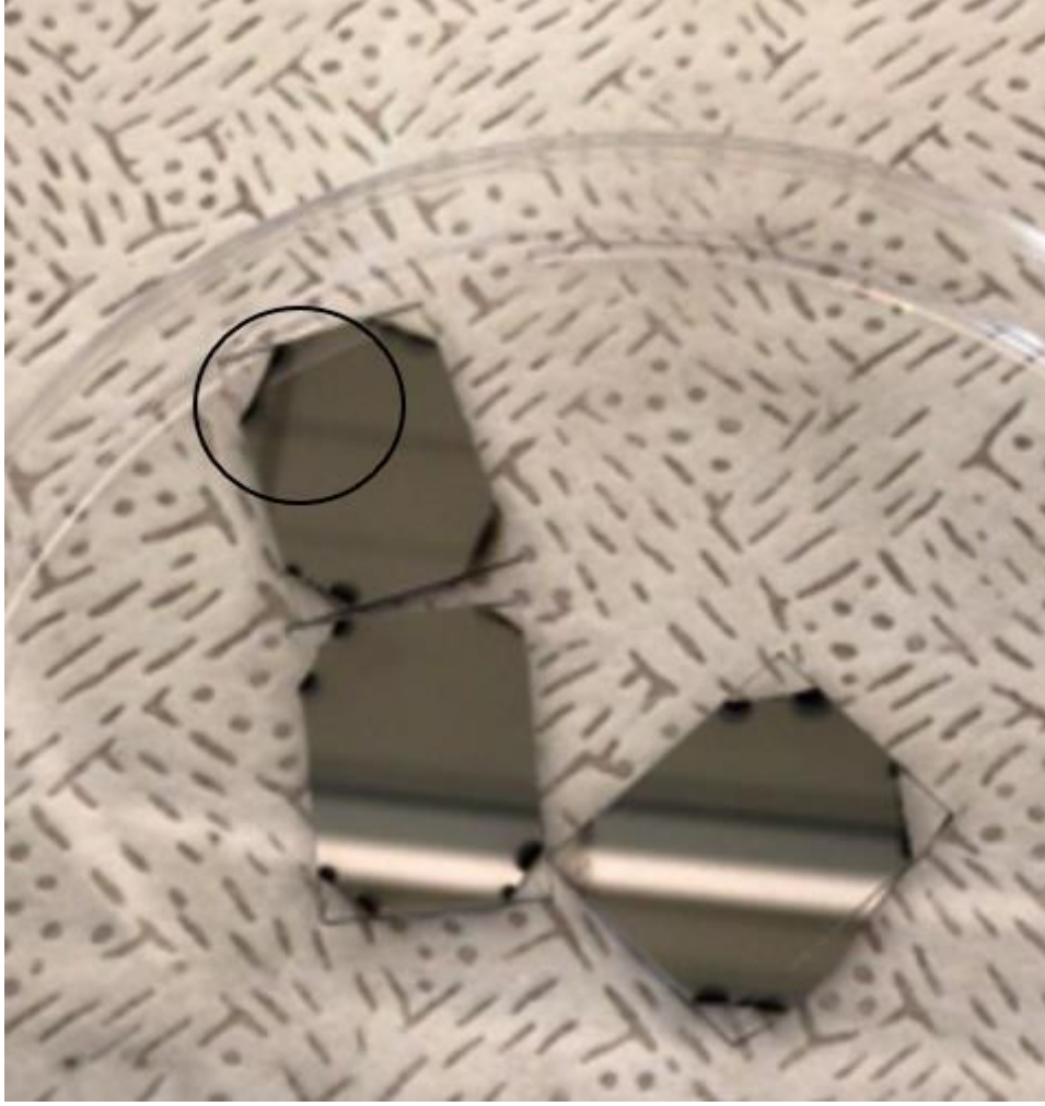
Şekil- 42: Şekil-43, a’da görülen CZTS örneğinin alttaşlar fotoğrafları. Yuvarlak içerisinde alınmış bölge Raman spektrumunda CuS fazının görüldüğü bölgeyi göstermektedir.
