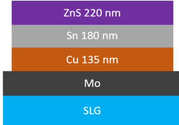
Şekil- 48: SLG/Mo/Cu/Sn/ZnS öncül filmin katman kalınlıkları ve sırasını veren şematik gösterimi.
