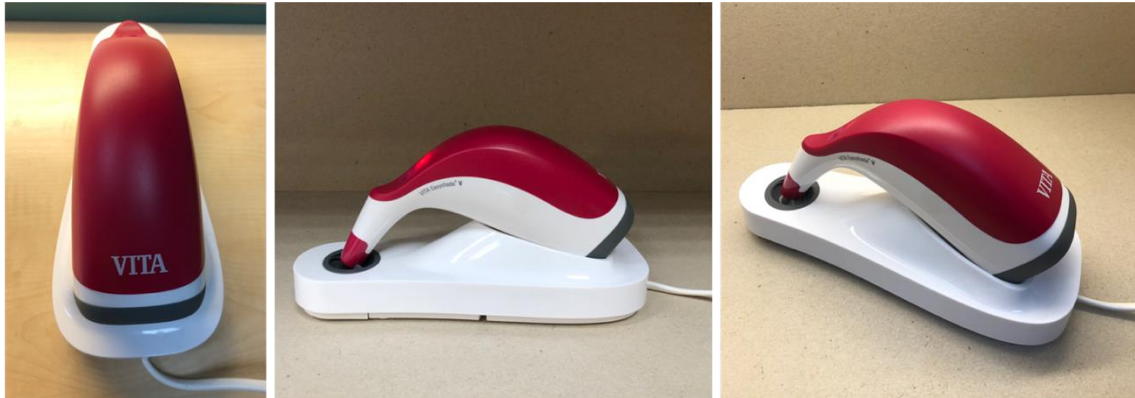
Şekil 3.12. VITA Easyshade Advance (VITA, Zahnfabrik H. Rauter GmbH & Co. KG, Almanya) spektrofotometre cihazı
