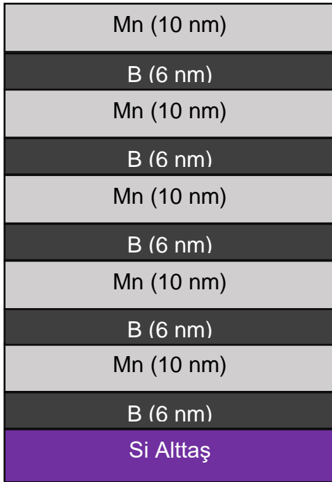
Şekil 12 5Mn/5B Çok katmanlı kaplama işleminin şematik gösterimi
