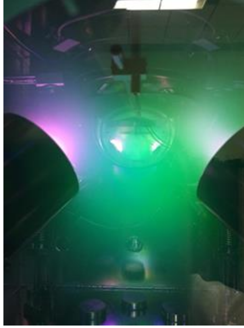
Şekil 13 Eş zamanlı sputter işleminin deneysel gösterimi
