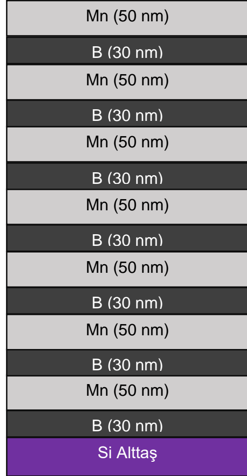
Şekil 11 7Mn/7B Çok katmanlı kaplama işleminin şematik gösterimi
