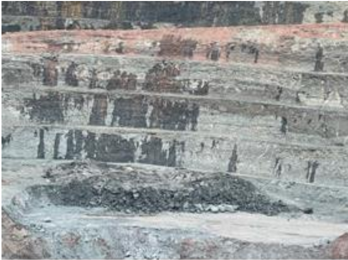
Şekil 3.12. Elektronik ateşleme sistemi ile gerçekleştirilen patlatma sonrası
