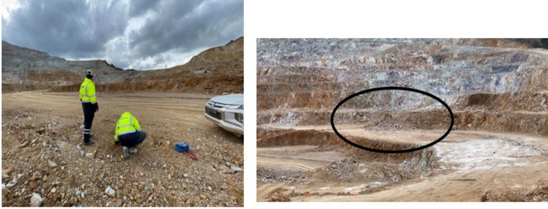
Şekil 3.22. Sismografların yerleştirilmesi ve patlatma grubu
