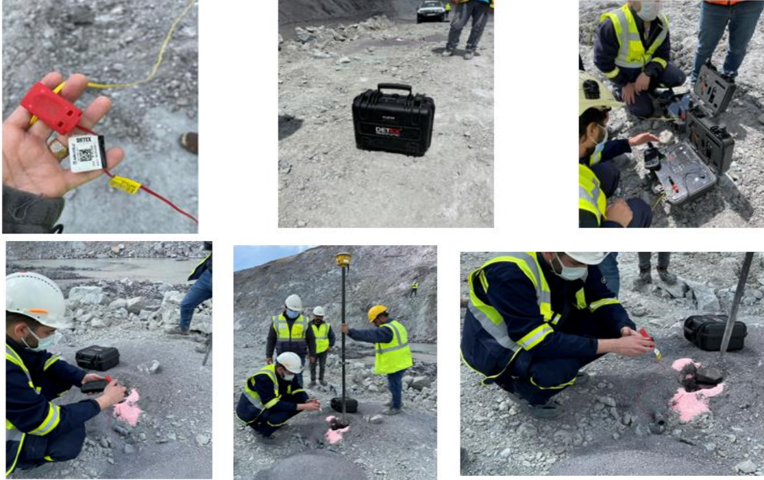
Şekil 3.15. Det-Ex elektronik ateşleme sistemi ile saha uygulaması
