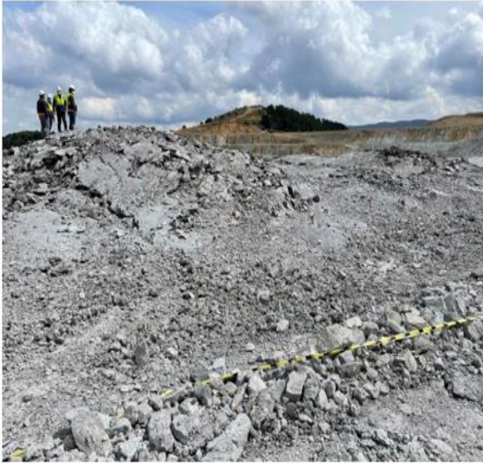
Şekil 3.21. Patlatma sonrası gerilme çatlakları
