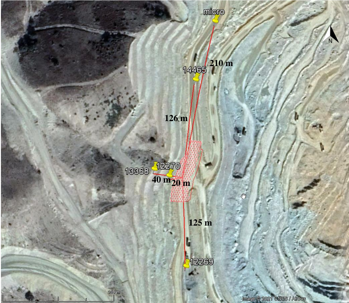
Şekil 3.19. Pilot ve grup patlatmasının ve sismografların yerleşimi
