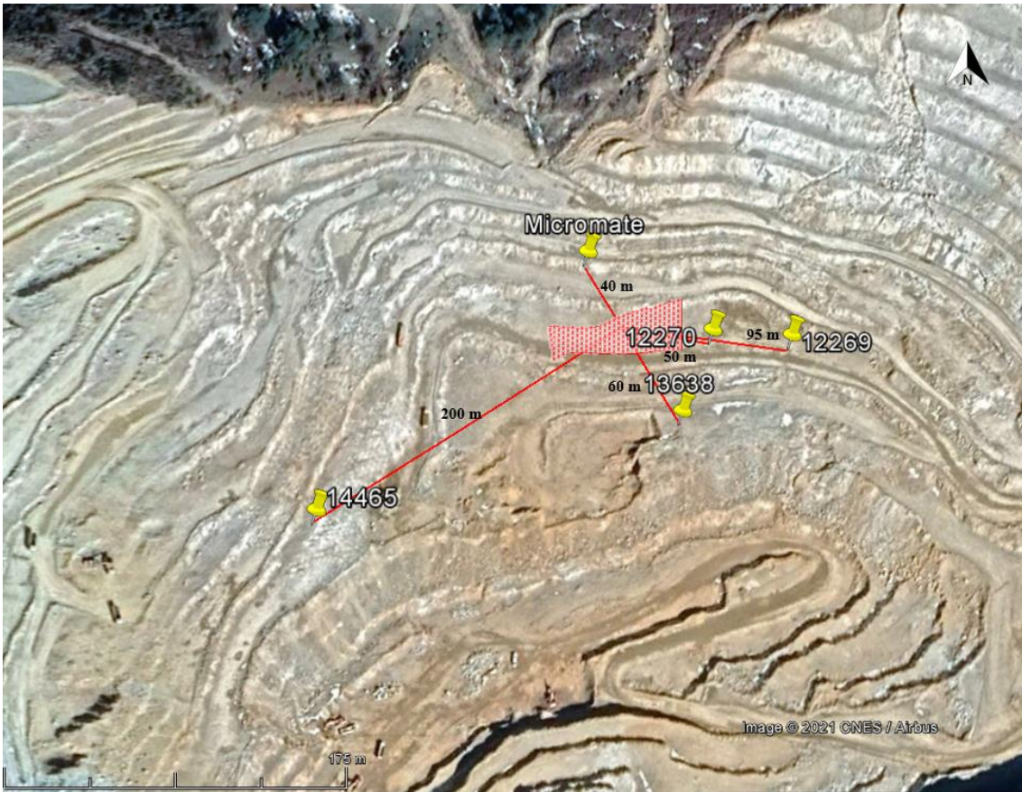
Şekil 3.25. Patlatma delikleri ve sismografların yerleşim
