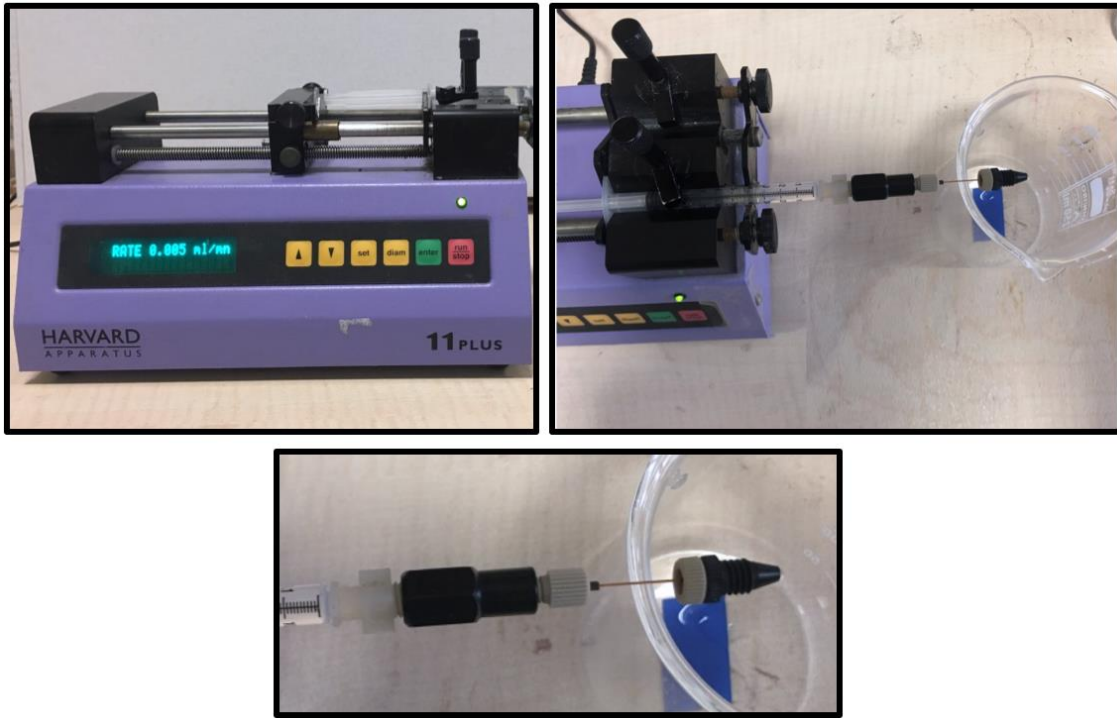
Şekil 3.3. Diol gruplu biyomoleküllerin izolasyonunda kullanılan sürekli mikroakış sistemi [69].
