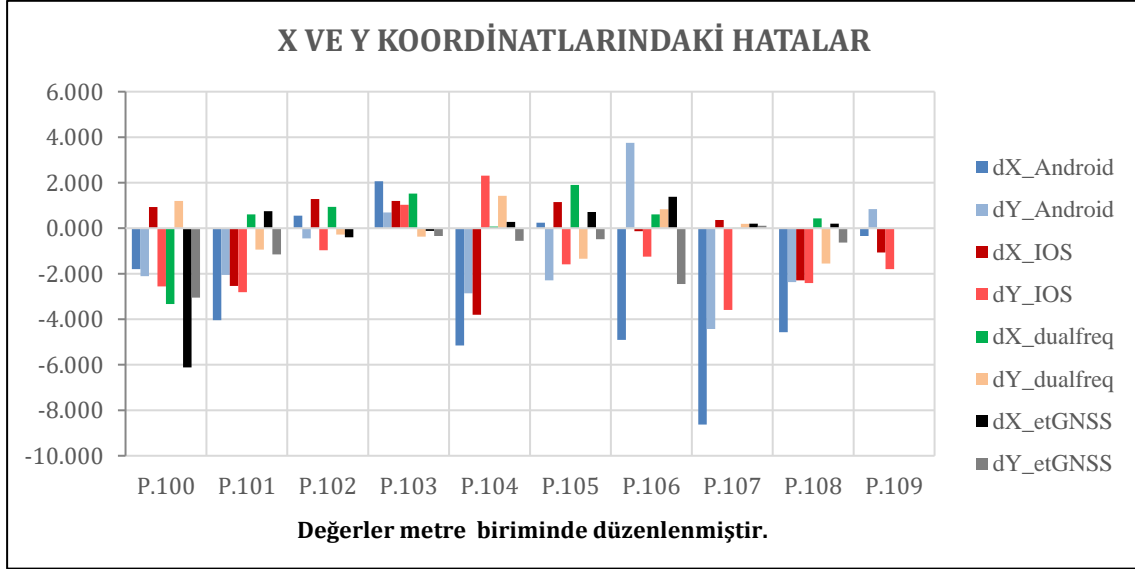
Şekil 4.3. Ayvacık ilçesindeki poligon noktalarında yapılan ölçülere ait X ve Y koordinatlarındaki hatalar.
