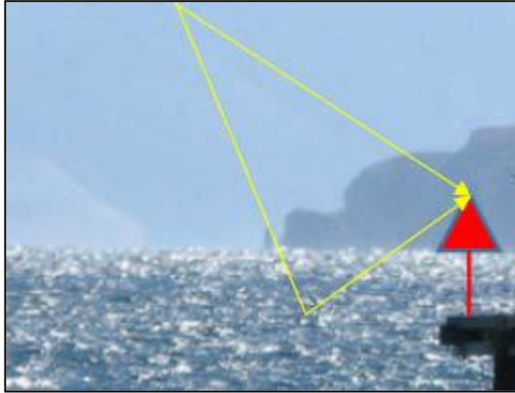
Şekil 2.16. Su yüzeyi kaynaklı sinyal yansıması [38].
