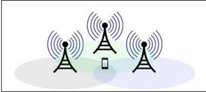
Şekil 2.36. Çok baz istasyonlu GSM ağı ile konum tespiti [60].
