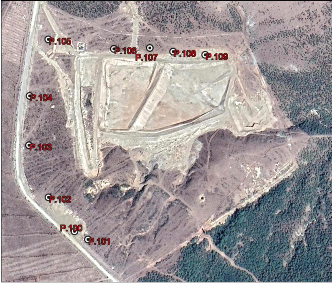
Şekil 3.6. Ölçü sahasında bulunan poligon noktaları.
