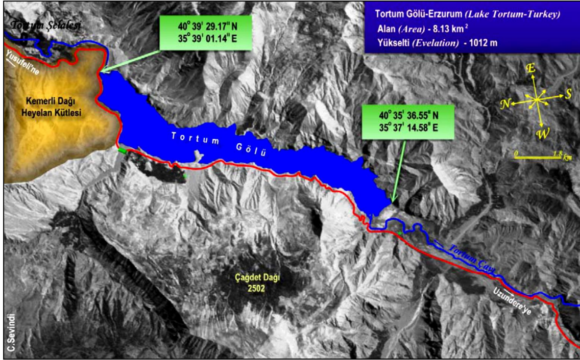
Şekil 2.30. Tortum Gölü çevresindeki heyelan sahasında el tipi GPS alıcısı kullanılarak elde edilen konum verisi [50].
