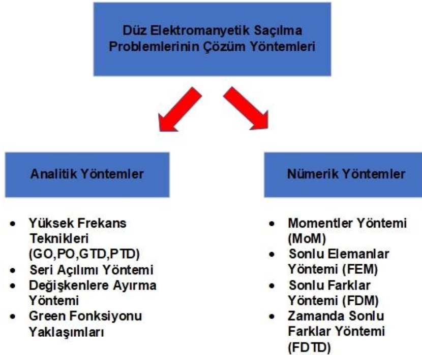
Şekil-1.7 Düz Elektromanyetik Saçılma Problemlerinin Çözüm Yöntemleri
