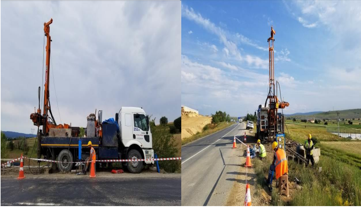
Şekil 5.4. Sahada gerçekleştirilen presiometre deneylerinden bir görüntü (Küçükçekmece – Sazlıdere bölgesi)
