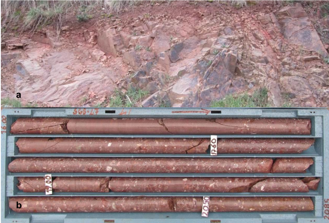
Şekil 4.3. Kurtköy formasyonuna ait seviyeler (Mostra(a) ve karot(b) görüntüleri – kumtaşı ve çakıltaşı örnekleri)
