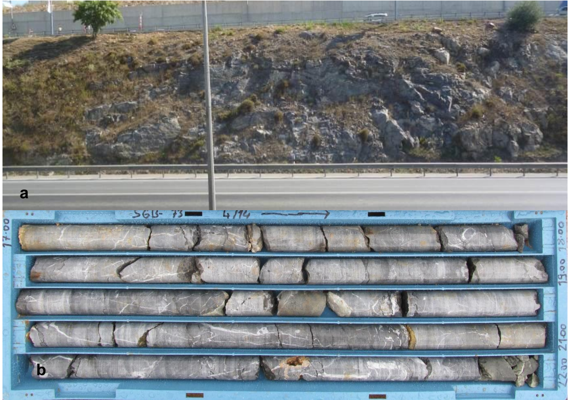
Şekil 4.5. Dolayoba formasyonuna ait seviyeler (Mostra (a) ve karot (b) görüntüleri – kireçtaşı örnekleri)
