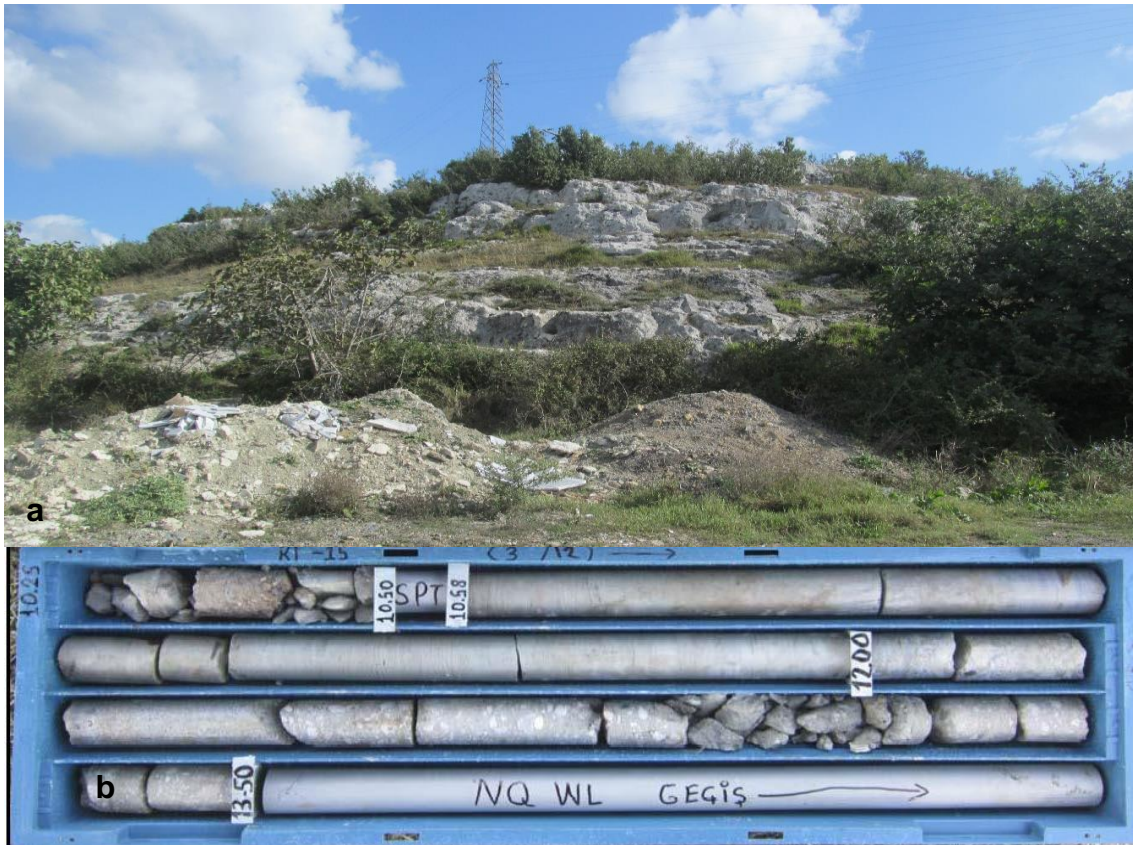
Şekil 4.8. Kırklareli formasyonuna ait seviyeler (Mostra (a) ve karot (b) görüntüleri – kireçtaşı örnekleri)
