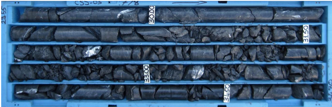
Şekil 4.6. Sondaj çalışmalarında kesilen Kartal formasyonuna ait seviyeler – kıltaşı örnekleri
