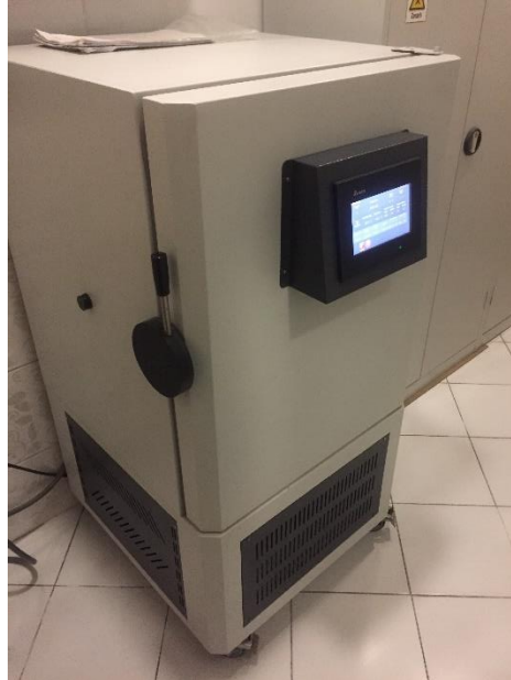
Şekil 3.5. “Microtest® MIT 120” iklimlendirme kabini
